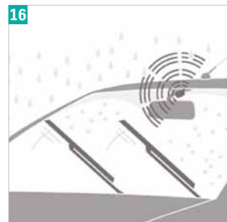
16 | Датчик дождя. Автоматически включает дворники лобового стекла, подбирает оптимальный режим и интервал их работы. 990E0-65J81-015
