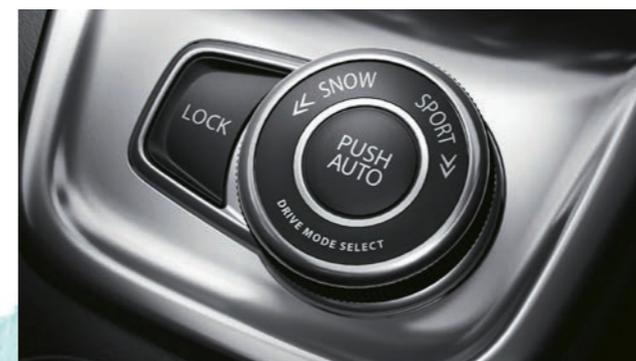
**4 РЕЖИМА: AUTO, SPORT, SNOW И LOCK** – обеспечиваются за счёт управления системой полного привода, двигателем, тормозами, усилителем рулевого управления и трансмиссией в соответствии с ситуацией на дороге.
